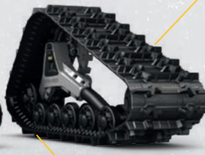
Gesamt-Bodenauffläche von 14.784 cm 2
